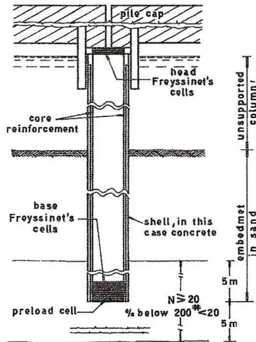
FIG.3. TEST PILE
