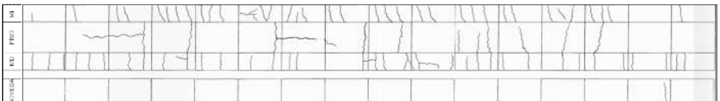
Fig. 3.2. Mapeo de fisuras en un tramo de un túnel excavado en un macizo rocoso. Fisuras transversales: tecnología del hormigón. Fisuras longitudinales en solera: subpresión. La bóveda prácticamente no tiene fisuras.
